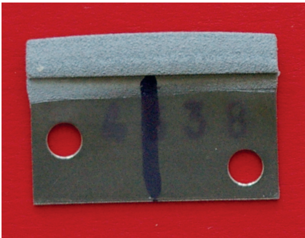
Bild 5 Testkörper mit Keramikschicht auf Metall, welche mit dem thermischen Spritzverfahren aufgebracht wurde: Foto der Probe (l.) und (r.) beispielhafte Messung an der grauen Keramikschicht (oben im Bild)
