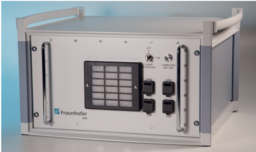
Bild 1 Ein Terahertz-Zeitbereichsspektroskopie-System besteht aus zwei Teilen: einem 19"-Rack als Basiseinheit mit Laser, Elektronik und Rechner (l.) und einem XY-Scanner, auf dem ein fasergekoppeltes Terahertz-Modul für Reflexionsmessungen montiert ist (r.)
